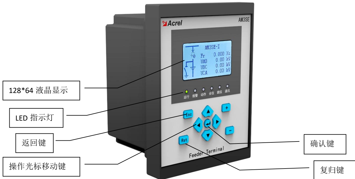
图 3.1 AM3SE 前面板
