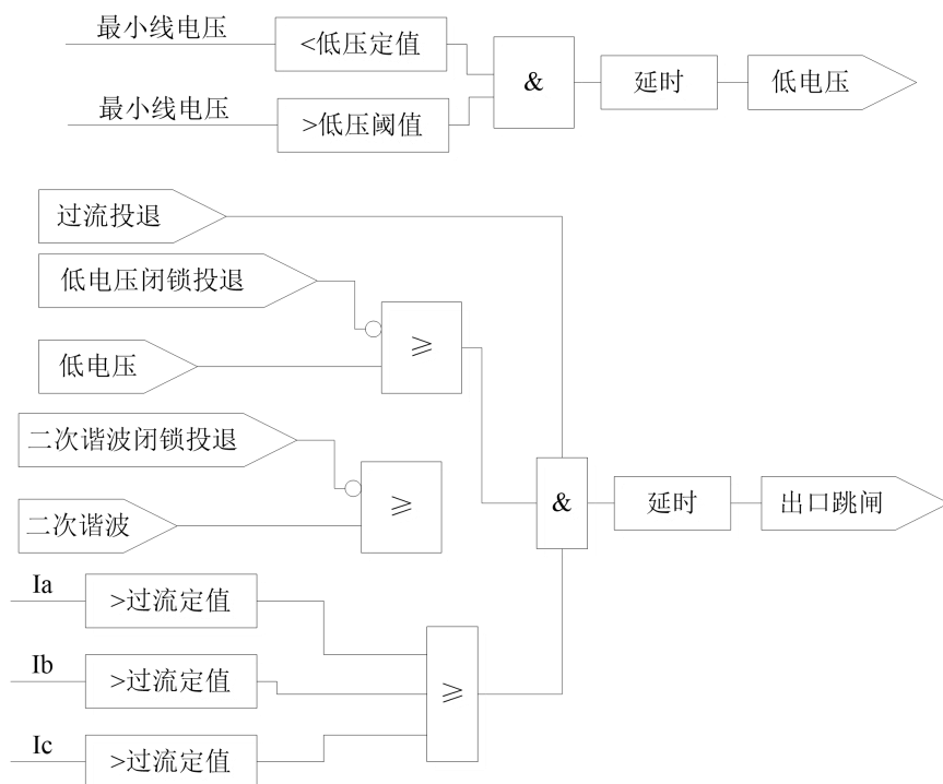
图 1.1 三段式过流保护逻辑
