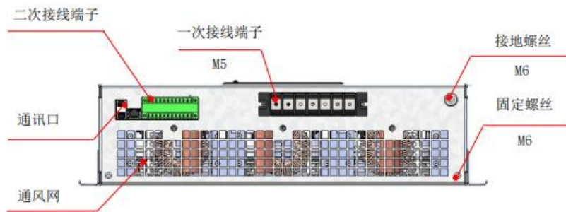
图4-20 30kvar壁挂式模块顶部
