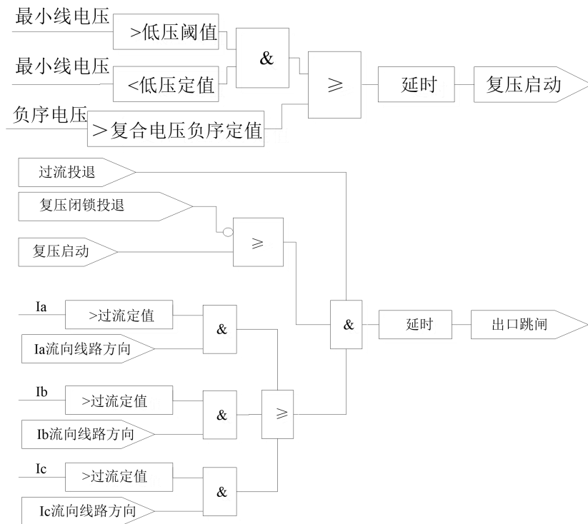
图 8.2 三段式过流保护逻辑
