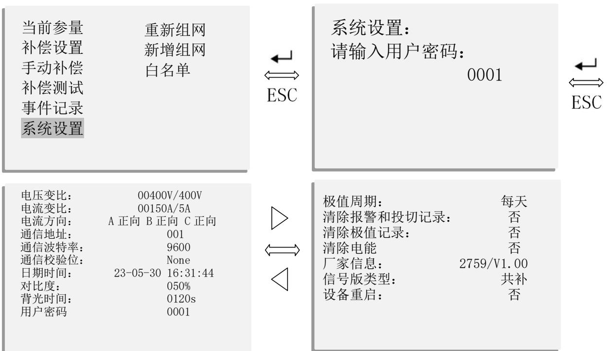
按“ESC”键至主菜单，通过“◀”、“▶”选择“系统设置”按“←”键进入，使用“◀”、“▶”输入密码“0001”，按“←”键进入，通过“◀”、“▶”选择要更改的设置，“←”键确认要更改的设置，使用“◀”、“▶”调整设置值，“←”键保存设置。
