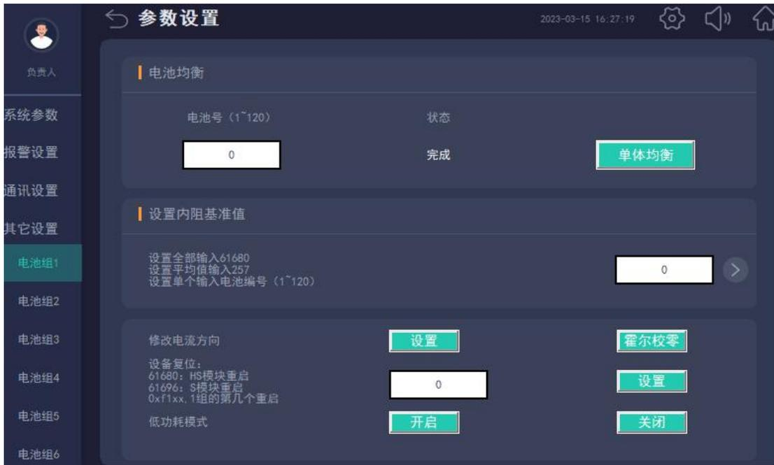
在其他设置页面中可对电池进行均衡设置、设置内阻基准值、修改电流方向、给设备复位、开启低功耗模式
