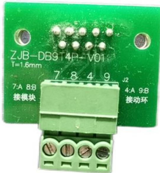
图 7 触摸屏配套转接板
