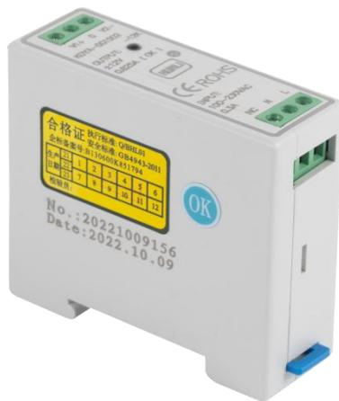
图9 KDYA-DG1502-12K开关电源图
