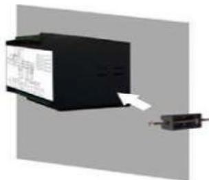
步骤 3：用螺丝刀将固定件上的螺丝按顺时针方向拧紧，直到控制器安装稳固为止。
