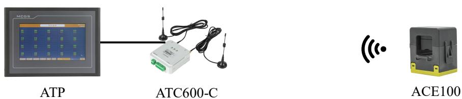
说明：触摸屏通过 RS485 接口连接一只 ATC600-C 实现集中数据显示，1 只 ATC600-C 可接收 240 只 ACE100 无线温度电流复合传感器的数据。
