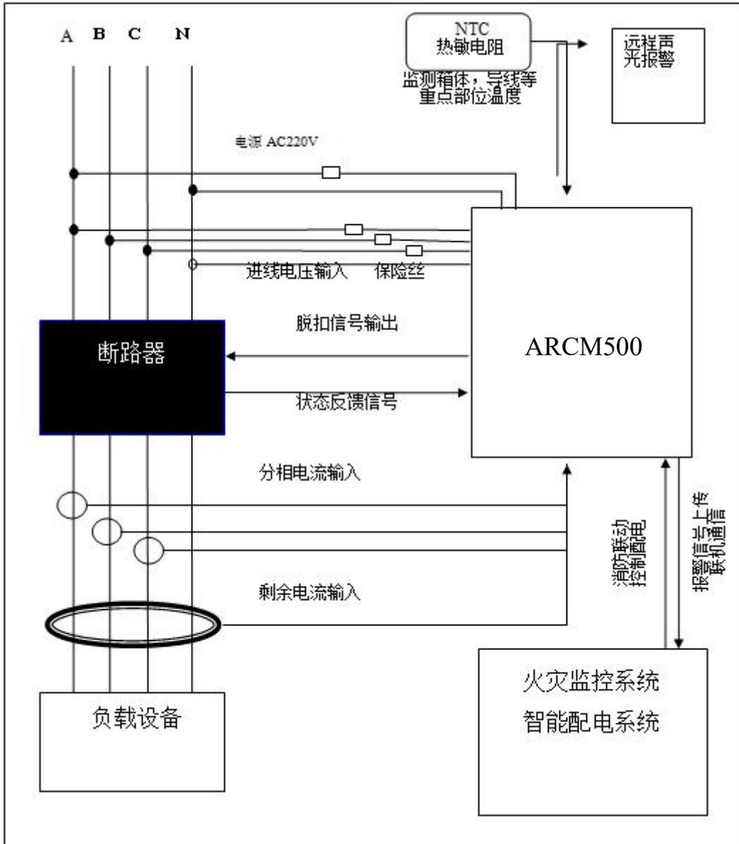
注：1、在安装接线时应注意剩余电流互感器的屏蔽层须接大地，若剩余电流互感器在断路器出线处不方便安装时，可以安装于断路器进线处，ABCN 必须同时穿过剩余电流互感器，且地线不能传进剩余电流互感器；电压采样信号也可以取自断路器出线处。
