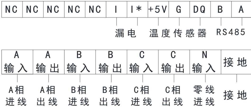
ASCP320 限流式保护器接线端子图
