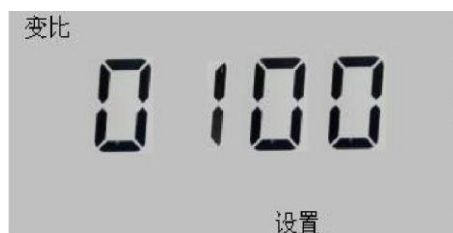
图 35 电流互感器变比
