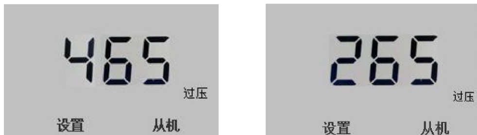
图 69 过压保护设置
