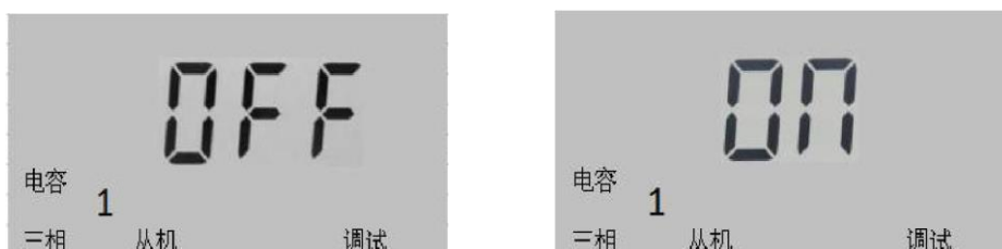
图 43 共补电容 1 投切状态
