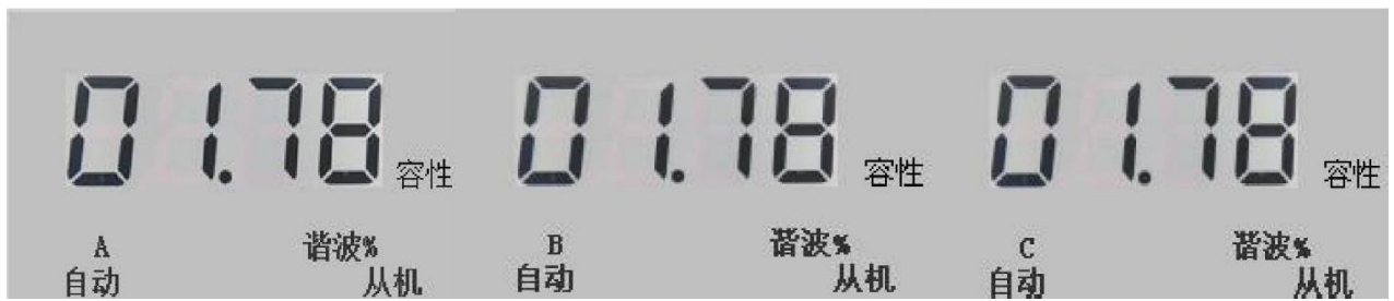
图 98 电压总谐波含量显示
