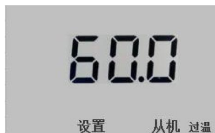
图 114 温度保护设置
