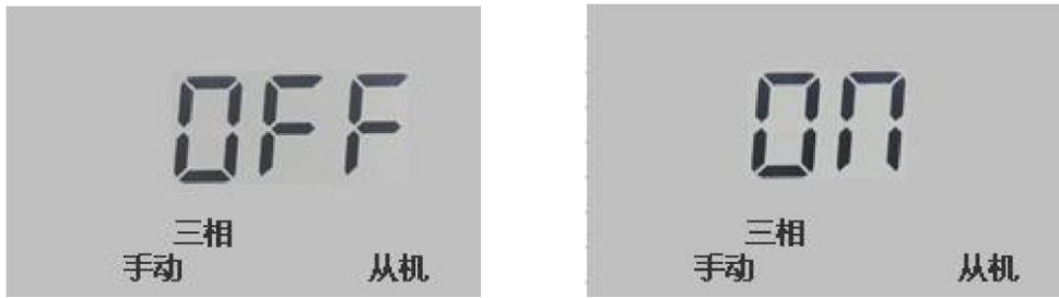
图 60 B相手动控制
