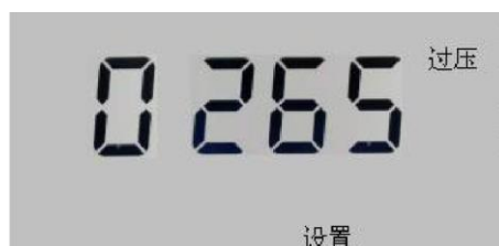
图 38 过压保护设置
