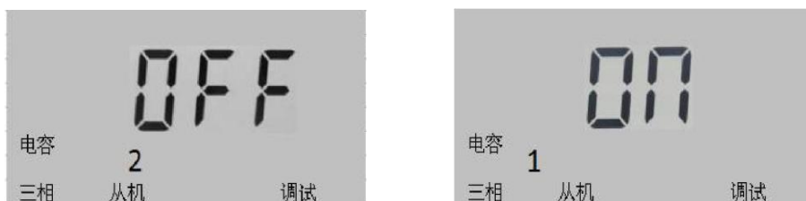
图 44 共补电容 2 投切状态
