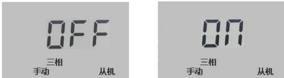
图 58 共补手动控制
