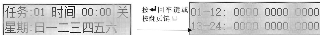
(2) 预约定时任务界面可查看 24 条任务，第一个界面显示每条任务的类型（分表示定时到了灯具关，合表示定时到了灯具开）、时间，第二、三和四界面显示控制的灯具。按 ◀ 左键或 ▶ 右键可切换下一条任务。
