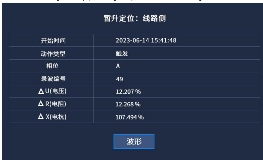
图 4.25(b) 电压暂升源定位-线路侧
