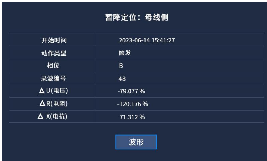
图 4.25(a) 电压暂降源定位-母线侧
