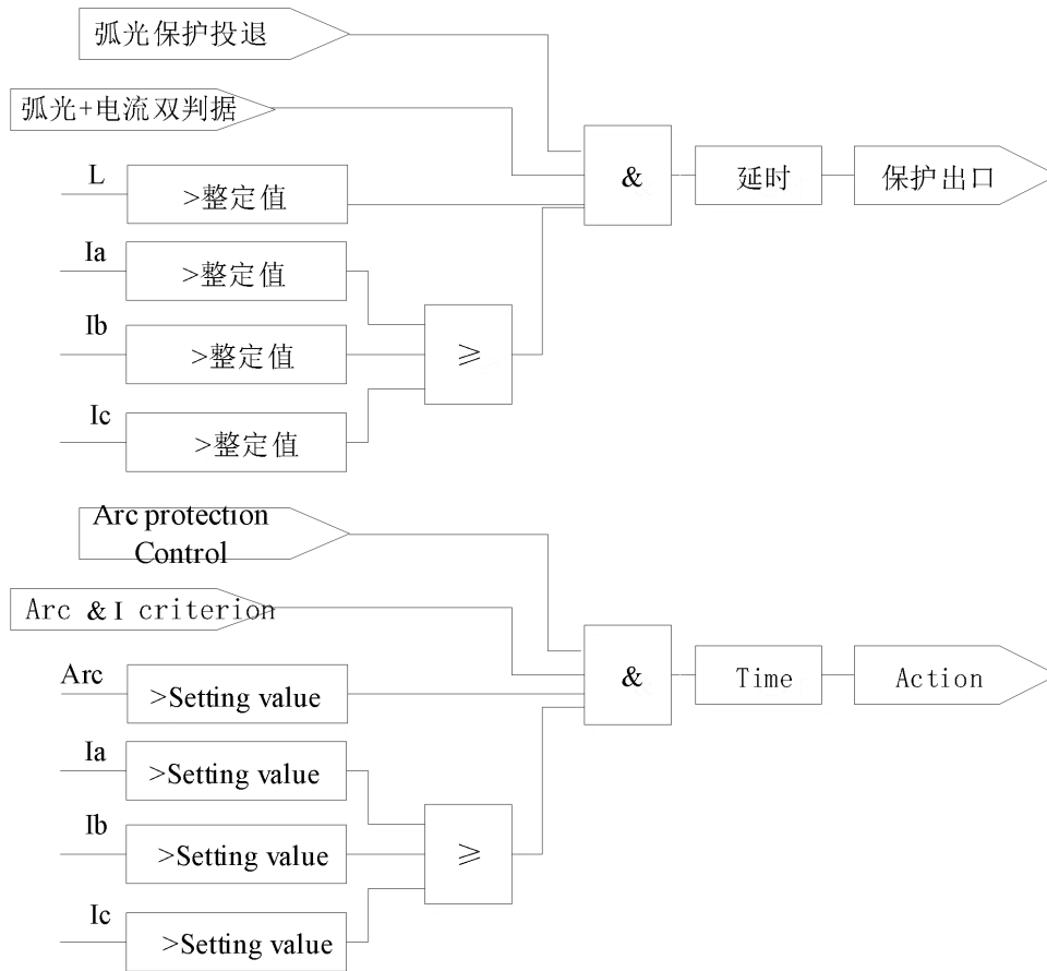
图1.2 弧光和电流双判据保护逻辑示意图
