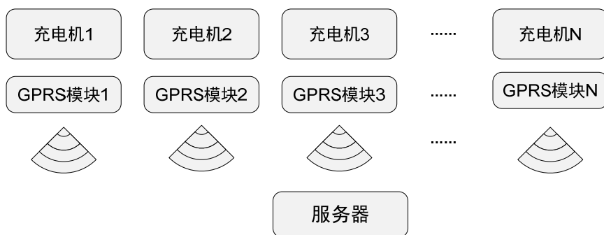
图 2-8 无线组网示意图
