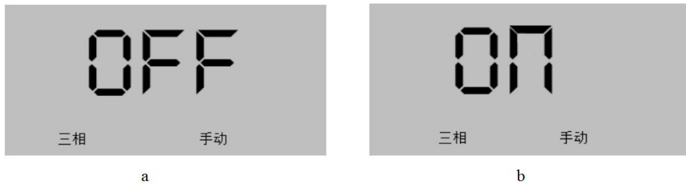
图 89 共补手动控制 a: 切除; b: 投入
