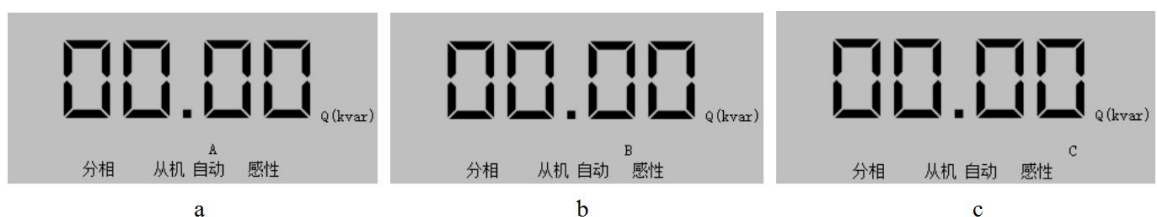
图 82 无功功率 a: A 相无功功率; b: B 相无功功率; c: C 相无功功率
