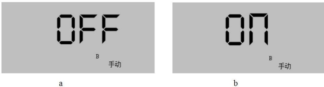
图 24 B 相控制 a: 切除; b: 投入
