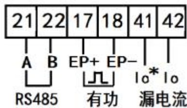
图 6 DDSY1352-4DM(5DM)辅助端子示意图
