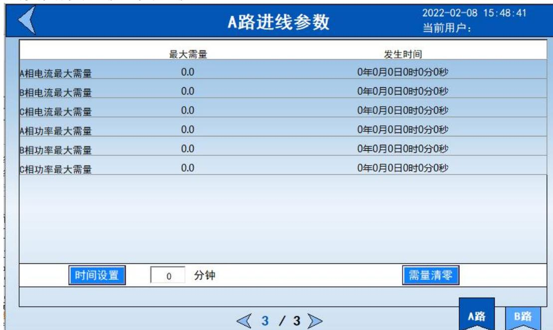
第 3 页为进线电流、功率最大需量。最大需量为进线的电流和功率的历史在设置的时间中产生的平均值的最大值。
