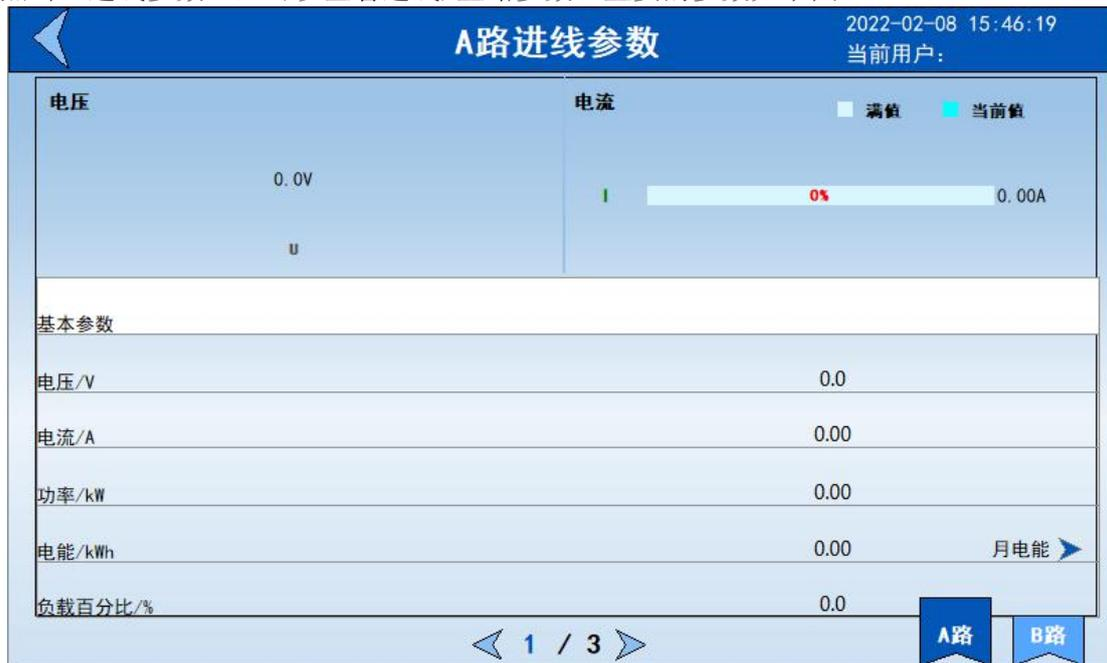
主要参数有电压、电流、功率、电能、负载百分比。
