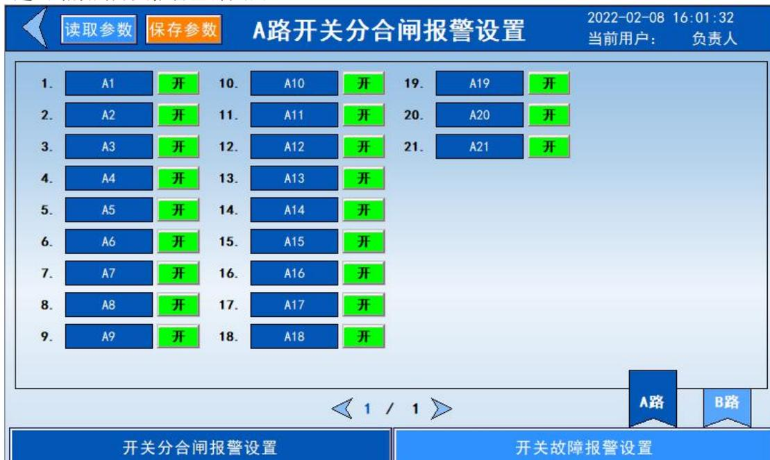
7.8.2.2 开关故障报警：若系统需求SD报警，则在“报警开关”列将该报警开启。“接线类型”列选择“常闭”则KD模块端子检测状态闭合为绿，断开为红，且由闭合至断开则产生主路跳闸报警，选择“常开”则KD模块端子检测状态闭合为红，断开为绿，且由断开至闭合则产生开关跳闸报警。
