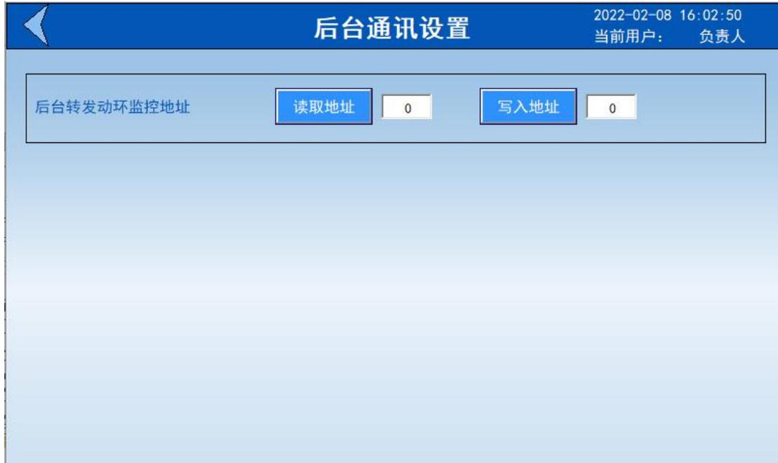
在写入地址右边填写后台动环监控系统需求的地址后点击“写入地址”，可读取地址检查是否已修改成功。
