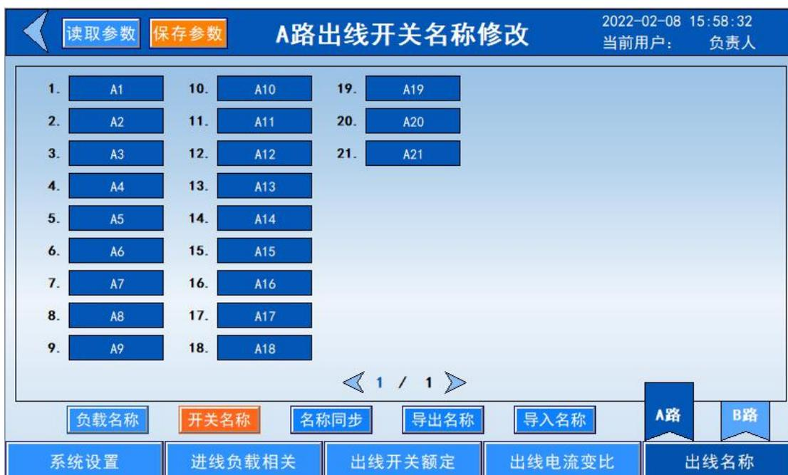
直接点击回路框可修改开关名称。点击“名称同步”为负载名称同步到开关名称。
