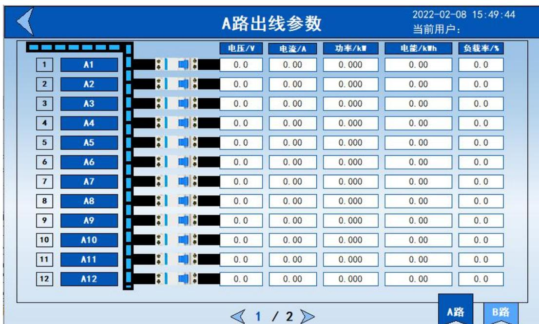
出线参数主要有电压、电流、功率、电能、负载率。
