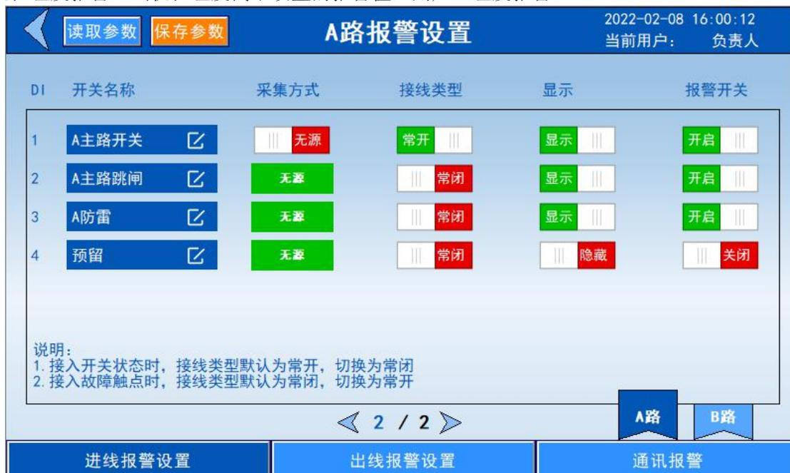
主路开关状态：“采集方式”列若选择“无源”是直接采集辅助触点开关信号，若选择“有源”则直接采集电压即可判断。“接线类型”列选择“常开”则 AMC 采集模块端子检测状态闭合为绿，断开为红，且由闭合至断开则产生主路开关报警，选择“常闭”则模块端子检测状态闭合为红，断开为绿，且由断开至闭合则产生主路开关报警。如果没有使用该功能可以在“显示”列选择“隐藏”则在开关状态界面取消该开关的显示。如果只需要显示不需要报警可以在“报警开关”选择“关闭”则主路开关只显示不报警。
