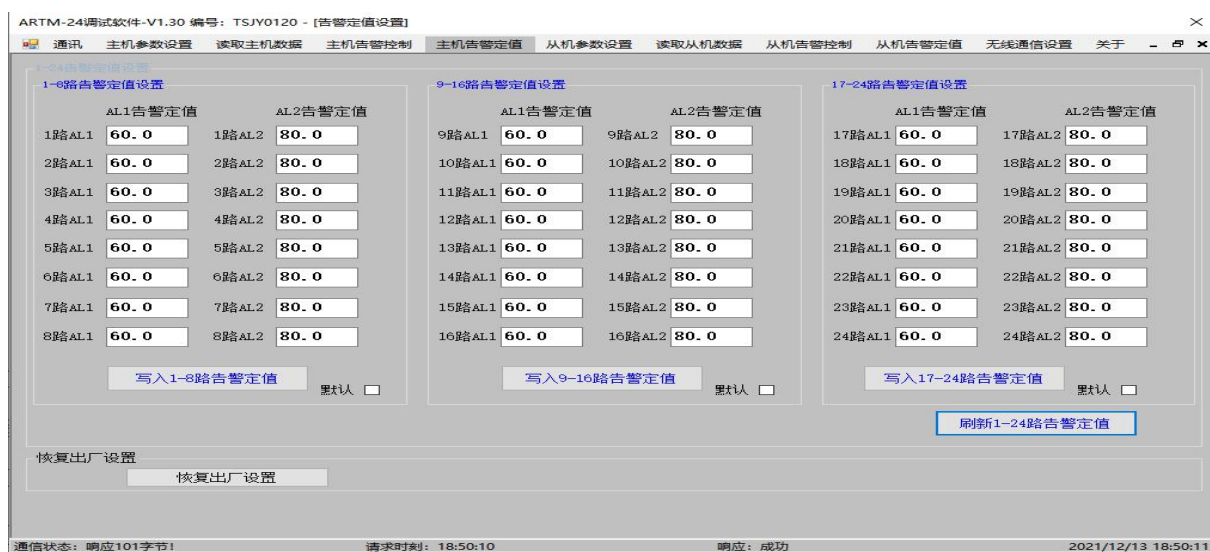
图 1.11 ARTM-24 调试软件主机告警定值设置
