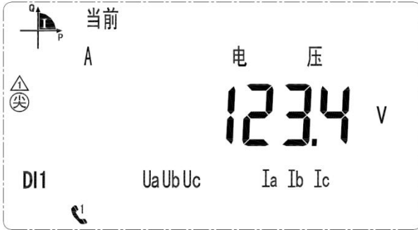
当前 A 相电压为 123.4V Voltage on A phase is 123.4V
