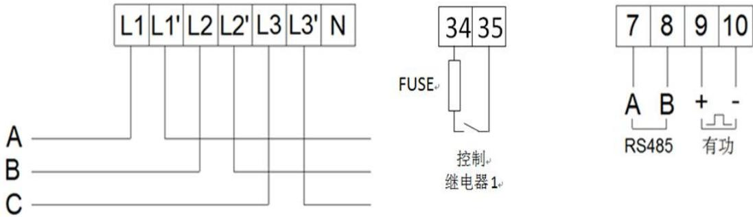
三相三线直接接入接线图
