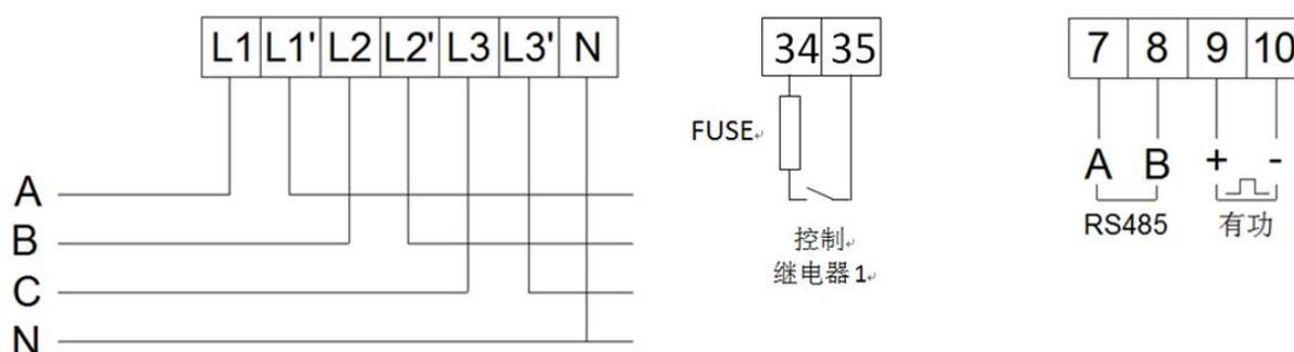
三相四线直接接入接线图
