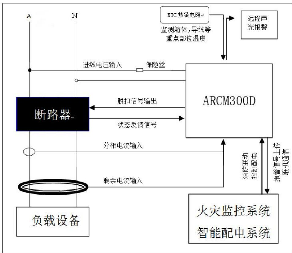
注：1、在安装接线时应注意剩余电流互感器的屏蔽层须接大地，若剩余电流互感器在断路器出线处不方便安装时，可以安装于断路器进线处，ABCN 必须同时穿过剩余电流互感器，且地线不能传进剩余电流互感器；电压采样信号也可以取自断路器出线处。
